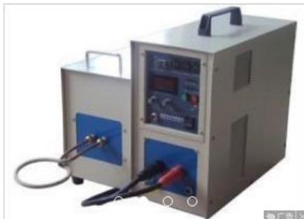
喷熔布机电磁加热器
